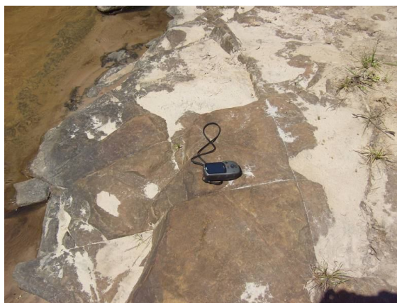
Figura 5: Fraturas identificadas no Arenito Silicificado.
