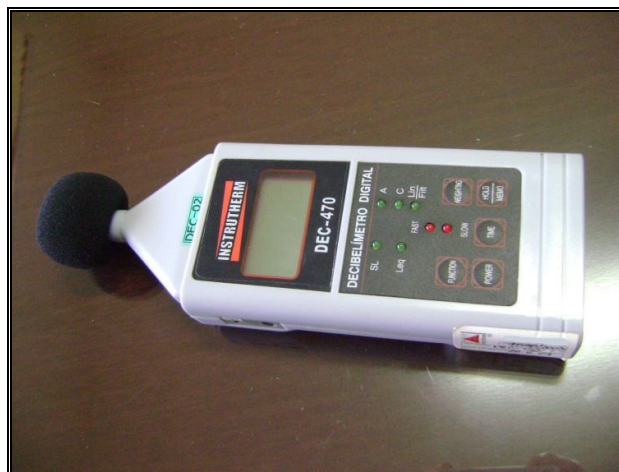
Figura 01 – Decibelímetro utilizado nas medições ambientais.
