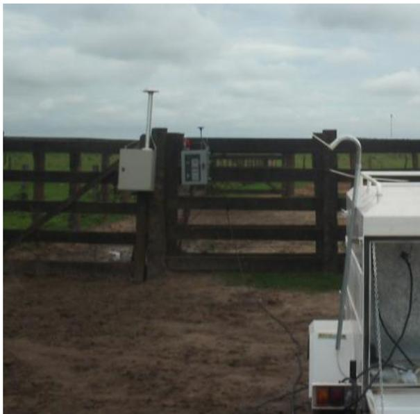
**Figura 4 – Amostradores de partículas em suspensão(PTS e MP<sub>10</sub>).**
