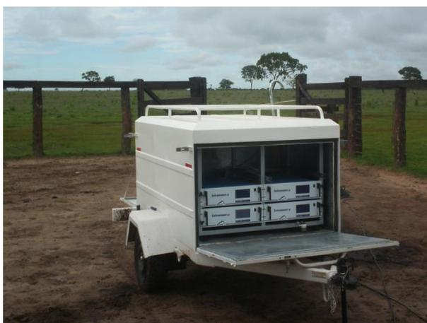
**Figura 3 – Analisadores de gases(  $NO_x$ ,  $SO_2$ ,  $O_3$  e  $CO$ ).**
