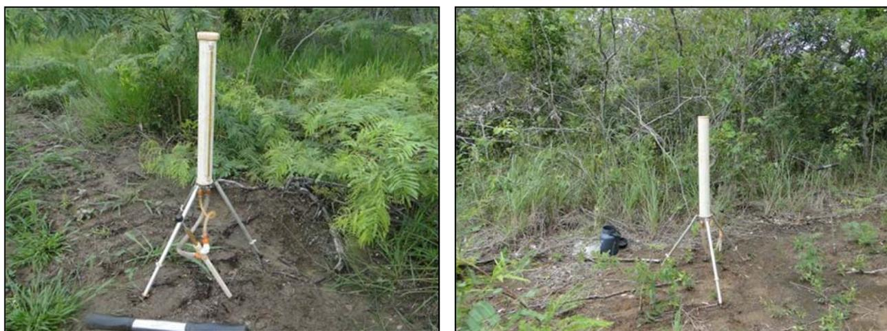
**Figura 7.26 - Detalhamento do permeâmetro de Guelph para a determinação da condutividade hidráulica do solo.**
