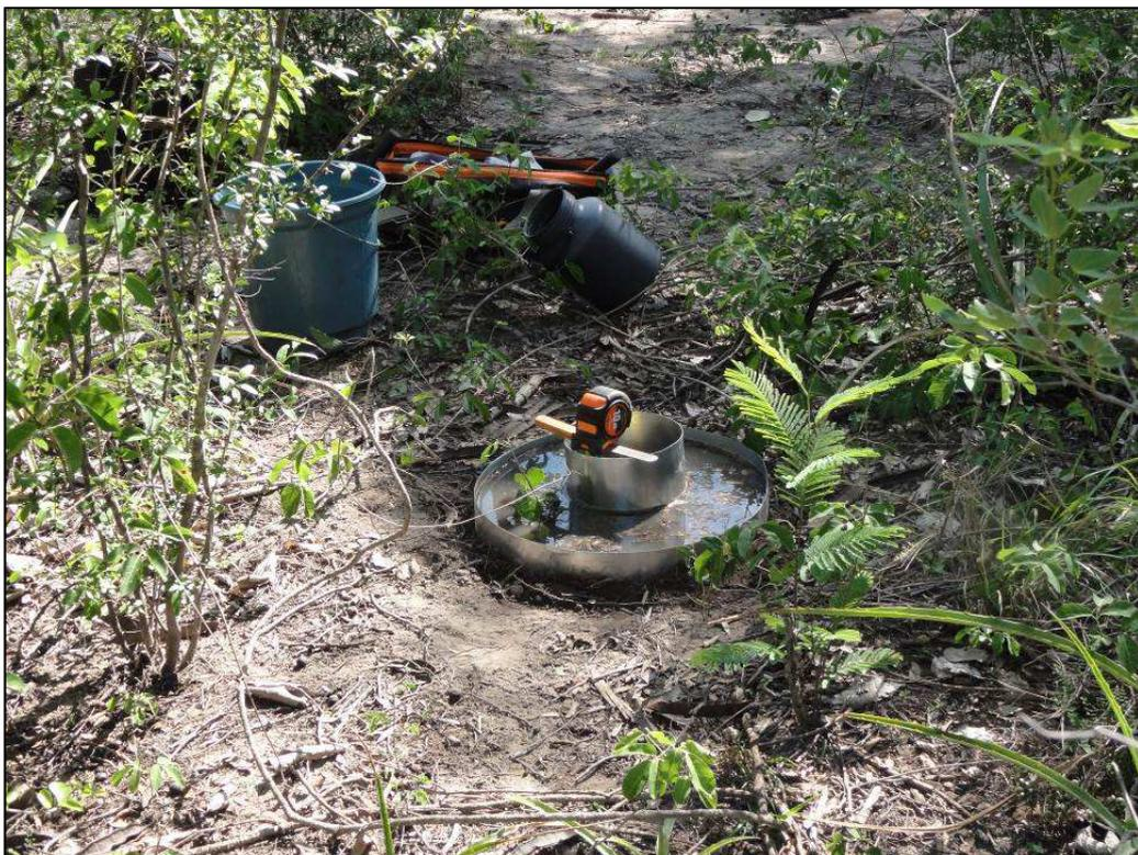
**Figura 7.25 - Foto ilustrativa de como foi determinada a velocidade básica de infiltração de água no solo.**
