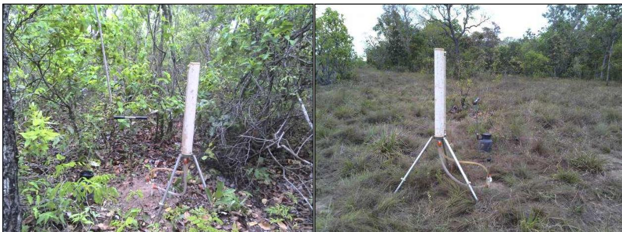
**Figura 7.27 - Detalhamento do permeâmetro de Guelph para a determinação da condutividade hidráulica do solo.**
