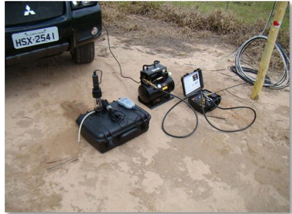
Figura 57 – Compressor “Oil Less” e Controlador de fluxo do sistema Low Flow.
