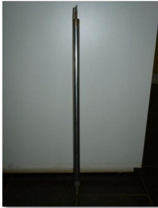
Figura 56 – Bomba confeccionada 100% em aço inox utilizada na coleta de amostras.
