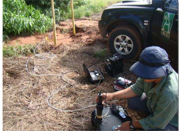
Figura 63 - Mostra sistema de micropurga, ou LOW FLOW, instalado e em atividade.
