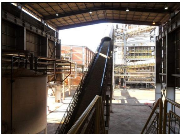
Figura 25 - Esteira alimentadora de bagaço para a Caldeira, visando à geração de vapor para o processo produtivo.
