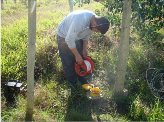
Figura 62 - Mostra técnico aferindo o nível de água e profundidade de poço de monitoramento.
