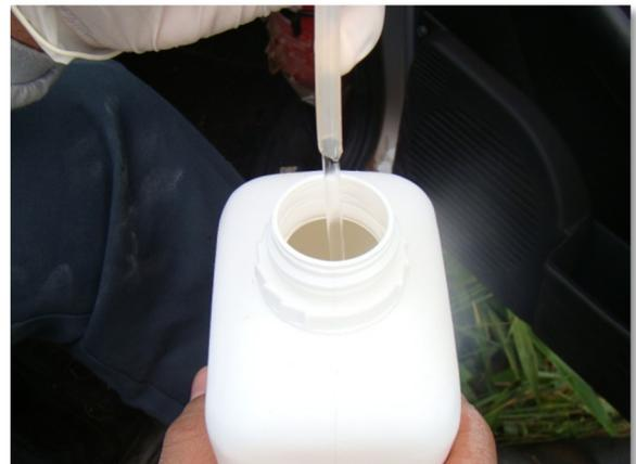
Figura 61 - Mostra preenchimento de frasco com amostra de poço de monitoramento, sendo notável a transparência da mesma.
