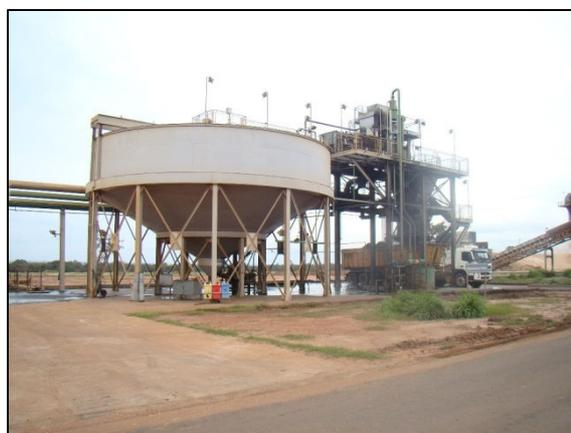
Figura 28 - Decantador das cinzas da caldeira para destinação e incorporação em área agricultáveis.
