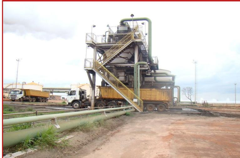
Figura 16 - Caminhão sendo carregado com cinzas após tratamento físico no decantador.
