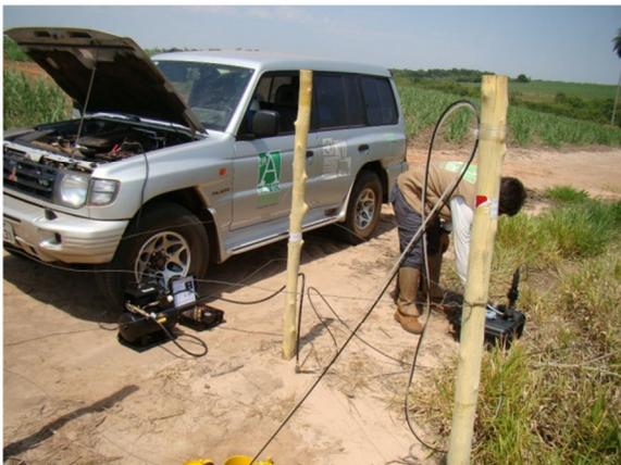
Figura 60 - Mostra técnico realizando a instalação dos aparelhos para amostragem por micropurga.
