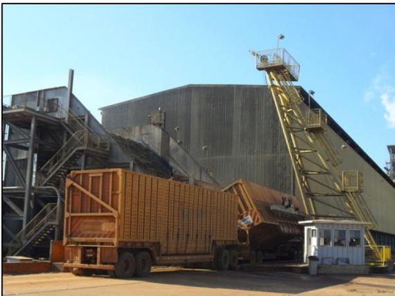
Figura 23 - Recepção da cana-de-açúcar na indústria através de mesa tombadora e Hilo.
