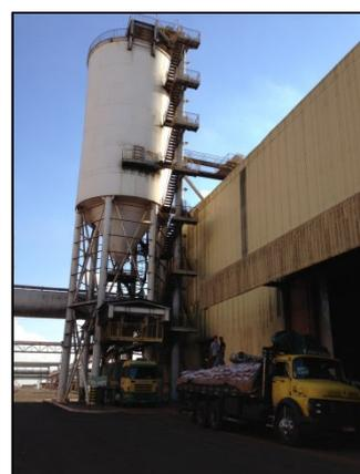
Figura 44 - Carregamento de açúcar a granel.
