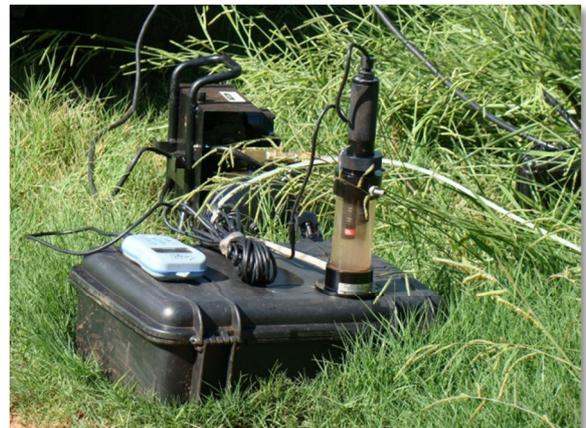
Figura 59 - Célula de fluxo e o Aquameter utilizado para leitura dos parâmetros verificados com a sonda.
