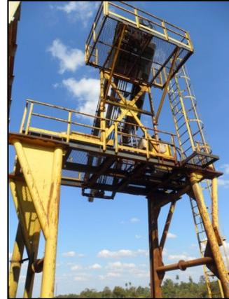
Figura 22 - Sonda Oblíqua para verificação do teor de sacarose de cana-de-açúcar. Setor conhecido como PCTS.
