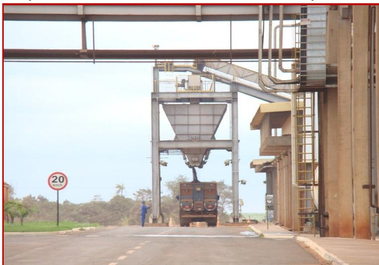
Figura 15 - Caminhão sendo carregado com torta de filtro da moenda. Fonte: Arater, 2013.
