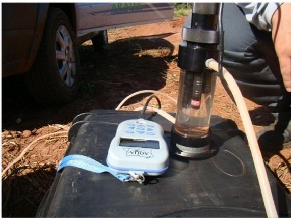
Figura 58 - Célula de Fluxo e Sonda Multiparâmetros utilizada para verificação in loco da qualidade das amostras.
