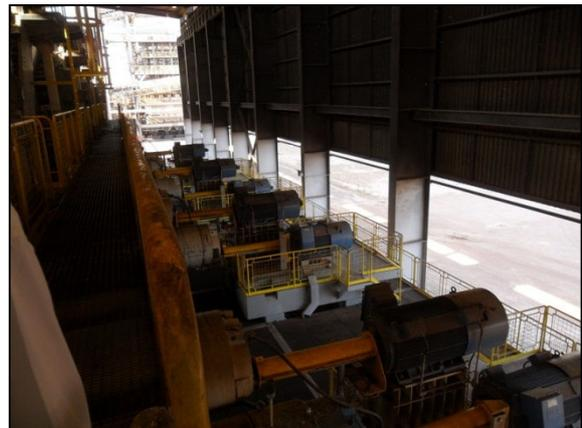
Figura 24 - Extração do caldo da cana-de-açúcar através de moenda. A imagem mostra os 5 ternos da moenda já instalados.
